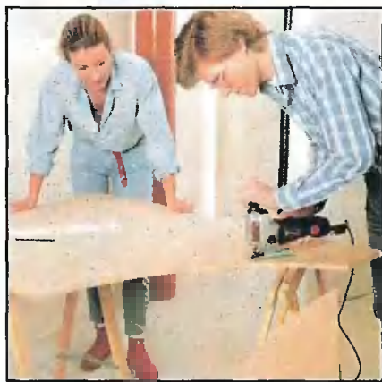
Чтобы пропил был аккуратным, в лобзик ставят мелкозубое полотно. Небольшие неровности зачищают шлифовальной шкуркой.
