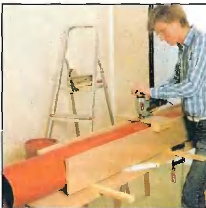
Ровно разрезать трубу на две одинаковые половинки можно электролобзиком, закреплённым на направляющих салазках.
