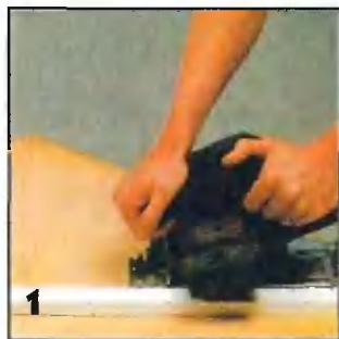
1 Детали полки с подсветкой (над умывальником) выкраивают из фанеры.
